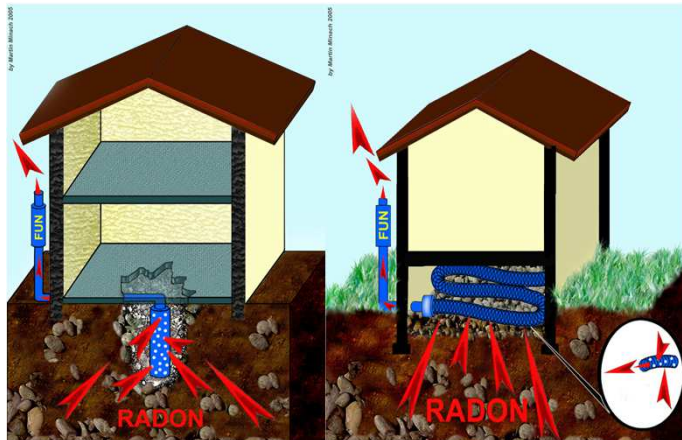
il pozzetto o sistema di drenaggio radon
